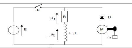
Une fois le courant établi dans la branche comportant le dipôle RL, À l'ouverture de l'interrupteur, le moteur tourne en soulevant la masse marquée : la bobine est à l'origine de l'établissement d'un courant électrique dans le circuit, elle avait donc auparavant emmagasiné de l'énergie.
