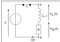
Un dipôle RL subit un échelon de tension lorsque l'on ferme l'interrupteur du circuit dans lequel un générateur de tension continue (E) est branché en dérivation aux bornes du dipôle RL. La tension u<sub>AB</sub> passe brutalement de 0 V à E V.
