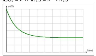
Si la bobine est idéale (r  $\approx$  0), la tension aux bornes de la bobine  $u_L(t)$  tend vers 0.
