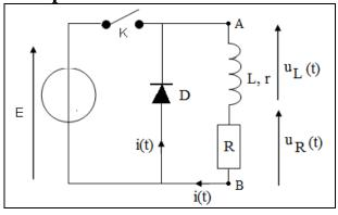
Un dipôle RL subit une rupture de courant lorsque l'on ouvre brutalement l'interrupteur du circuit dans lequel un générateur de tension continue (E) est branché en dérivation aux bornes du dipôle RL. La tension u<sub>AB</sub> passe brutalement de E à 0 V.
